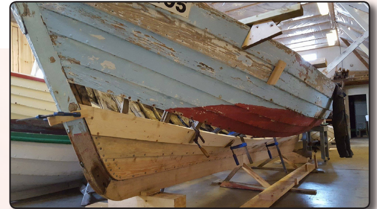
Gunnhildur ÓF18, 2 brl. afturbyggður súðbyrðingur úr furu og eik frá árinu 1982. Á síðasta ári var skipt um kjól og byrjað að skipta um byrðing. Áfram verður unnið að viðgerð Gunnhildar á námskeiðinu í þar.
